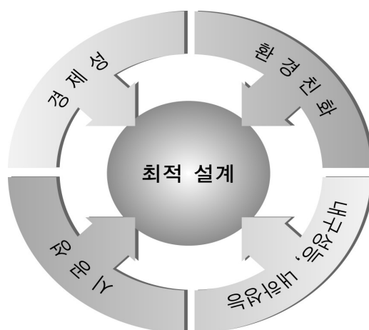
[보수·보강 방안 선정의 요건]
